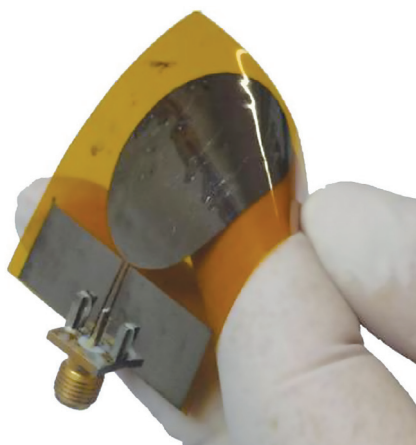
Obr. 1 UWB anténa vyrobená technológiou InkJet Printing na polyimidovom substráte Kapton® HN [4].
