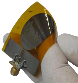
Obr. 2 UWB anténa vyrobená technológiou InkJet Printing na polyimidovom substráte Kapton® HN.
