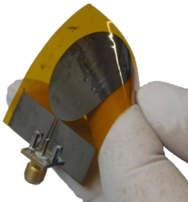
Obr. 1.2 Príklad použitia fólie Kapton® HN v podobe UWB antény [8]
