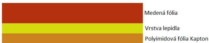
Obr. 1.4 Substrát s nanesenou medenou vrstvou na jednej strane - Pyralux.
